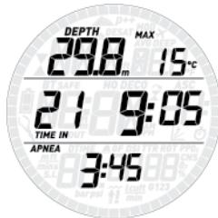
Stisknutím a podržením tlačítka **UP** vstoupíte do série, kde je v horním řádku zobrazena maximální hloubka a minimální teplota ponoru, v prostředním řádku čas ponoru a sekvenční počítadlo ponorů a ve spodním řádku povrchový interval před ponorem.
