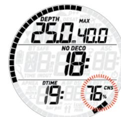
Když dosáhne kyslíkovou toxicitu úrovně 100 %, alarm se po prvním spuštění opakuje každých 5 sekund v intervalu jedné minuty a přetrvává, dokud hodnota CNS zůstává nad 100 %. Zvažte okamžité ukončení ponoru!
