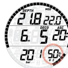
Stiskněte a přidržte tlačítko **DOWN** a potvrďte přepnutí na G2: nastavená koncentrace kyslíku přestane v pravém dolním rohu displeje blikat a zůstane svítit. Do 20 sekund se doba výstupu aktualizuje a nyní odráží vyšší koncentraci kyslíku v dýchacím plynu.
