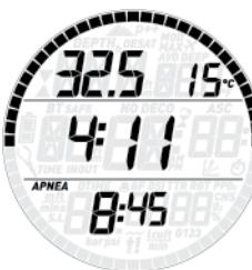
Režim freedivingového potápění opusťte stisknutím a podržením tlačítka **UP**. To provádějte vždy až po ukončení celé série a uložení všech jejích ponorů do deníku (více informací o deníku v režimu freedivingového potápění najdete v části 3.7.3). Nezapomeňte, že počítač Smart Air automaticky ukončí režim freedivingového potápění vždy, jestliže se potápěč po dobu 30 minut opět neponoří.
