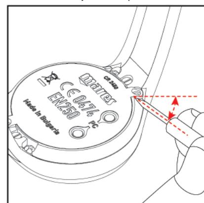
c) Odklopte kryt a vyjměte O-kroužek. Vyhodte ho do odpadu.
