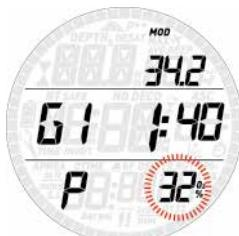
Po vstupu do tohoto menu použijte tlačítka UP nebo DOWN pro změnu nastavení O<sub>2</sub>% a sledujte, jak tato změna ovlivňuje maximální operační hloubku (MOD). Poté stiskem
