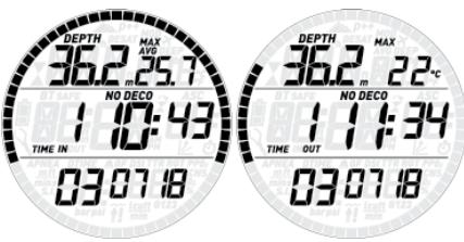
Stisknutím a podržením tlačítka **UP** přejdete na následující stránku deníku, na které je ve spodním rádku uveden povrchový interval před ponorem střídající se s časem ponoru a **CNS** (střídá se počáteční a koncová hodnota).
