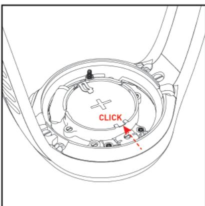
f) Vložte nový O-kroužek z kitu do drážky kolem baterie. O-kroužek musí přitom správně dosednout k vnějším okrajům drážky.
