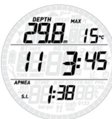
Po stisknutí tlačítka **UP** se v horním řádku displeje zobrazí maximální hloubka a minimální teplota série, v prostředním řádku maximální čas ponoru série a ve spodním řádku denní čas. Aby se tento „souhrn série“ odlišil od souhrnu jednotlivých ponorů, body v horní polovině displeje svítí.
