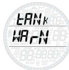
Páté menu, **tANK RSRV** (Alarm rezervy), je hodnota, při které dojde ke spuštění alarmu, neboť byste před jejím dosažením měli již být na hladině. Dále tato hodnota slouží k výpočtu hodnoty **TTR** (viz části 3.2.5 a 3.3). Lze jej nastavit individuálně pro každou láhev (**G1**, **G2** nebo **G3**). Výchozí hodnoty jsou **50 barů** a **500 psi**.
