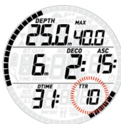
Když tlak v láhvích dosáhne hodnoty uvedené v **tANK RSRV** (Alarm rezervy), začne blikat oblouk představující tlak v láhvích a číselná hodnota tlaku a současně se spustí zvukový alarm. Stisknutím libovolného tlačítka vezmete alarm na vědomí. Alarm se vypne, avšak body znázorňující tlak v láhvích budou i nadále blikat. Pokud nebyla hodnota tlaku v láhvích zobrazena na displeji před spuštěním alarmu, displej se po vypnutí alarmu vrátí zpět na čas ponoru.
