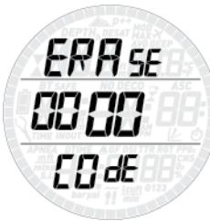
Smart Air umožňuje resetovat zbývající dobu desaturace. Veškeré informace týkající se nasycení tkání z předchozího ponoru tak budou nastaveny na nulu a počítač nebude považovat další ponor za opakováný. To je užitečné, pokud půjčujete počítač jinému potápěči, který se v předchozích 24 hodinách nepotáplí.
