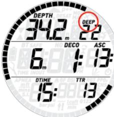
Po dosažení optimálního rozmezí pro provedení hloubkové zastávky (+/- 1 m od zobrazené hloubky), se tato hloubková zastávka zobrazí v pravém horním rohu společně s blikajícím označením **DEEP**. Současně se zobrazí blikající odpočítávání indikující průběh zastávky. Hloubkové zastávky lze v příslušném menu nastavení deaktivovat.
