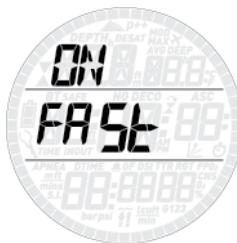
Nekontrolovaný výstup je definován jako výstup rychlostí vyšší než 12 m/min, který přetravává po více než dvě třetiny dráhy výstupu. Tento alarm je používán pouze u ponorů hlubších než 12 m. V takovém případě se počítač Smart Air kvůli potenciálnímu utváření bublin v tkáních na 24 hodin zablokuje, címkou má potápěče zabránit v opakování ponoru. V tomto menu můžete vypnout počítače v případě nekontrolovaného výstupu deaktivovat.
