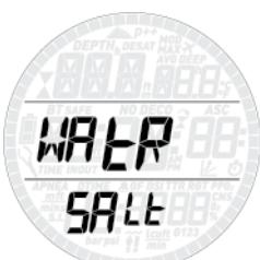
Počítač lze v závislosti na místě ponoru nastavit na **FRESH** (sladkou) vodu nebo **SALT** (slanou) vodu případně na vodu podle **EN-319**. Nastavení nesprávného typu vody bude mít za následek chybu v měření hloubky o velikosti přibl. 1-3 % (tj. v hloubce 30 m bude počítač nastavený na slanou vodu ukazovat hloubku 29 m, zatímco počítač nastavený na sladkou vodu bude zobrazovat hloubku 31 m). Tento fakt
