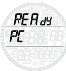
Toto submenu umožňuje stáhnout data ponoru do počítače PC nebo Mac. Stisknutím tlačítka **ENTER** zobrazíte na displeji text **PC ready** (Počítač je připraven), který značí, že Smart Air je připraven komunikovat.
