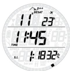
Poponorový displej je výchozím displejem, pokud ovšem není bezodletový nebo desaturační čas větší než 0 minut. Stisknutím tlačítka **DOWN** můžete procházet všechny ostatní obrazovky, nicméně počítač Smart Air se po uplynutí 8 sekund vždy automaticky vrátí do poponorového zobrazení. Dokud trvá desaturace, uchovává si Smart Air také zkrácený záznam posledního ponoru: maximální a průměrnou hloubku v horním
