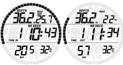
Pokud při ponoru používáte více než jeden plyn, pak se při stisknutí tlačítka **UP** zobrazí tlak a informace O<sub>2</sub> pro plyn G2 a po dalším stisknutí tlačítka **UP** se zobrazí případně informace pro plyn G3.
