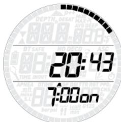
Při zobrazeném sekundárním času se při stisknutí a podržení tlačítka **DOWN** střídavě přepíná hlavní čas a sekundární čas.
