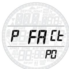
Smart Air umožnuje nastavit osobní bezpečnostní faktor pro situace, ve kterých potřebujete být zvláště opatrní, jako např. po dlouhé době bez potápění nebo při plánování náročného ponoru. V tomto menu můžete volit mezi standardním algoritmem (**P0**), jeho konzervativnější verzí (**P1**), případně maximálně konzervativní (**P2**). Ve zobrazení předponorového a poponorového režimu, v záznamníku a v plánovači se P1 zobrazuje jako p+, P2 jako p++ a P0 je indikováno chybějícími symboly.
