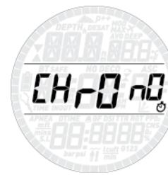
Do tohoto menu vstoupíte stisknutím a podržením tlačítka **UP**. V prostředním řádku jsou nyní zobrazeny stopky a denní čas se přesunul do spodního řádku displeje. Stisknutím tlačítka **UP** zahájíte a ukončíte čas odpočítávání a poté stisknutím tlačítka **DOWN** čas vynulujete. Stisknutím a podržením tlačítka **DOWN** opustíte funkci stopek (pokud stopky běžely, pak se tímto zastaví, případně pokud se čas zastavil na nenulové hodnotě, dojde při ukončování funkce k jejich resetování).
