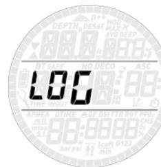
Smart Air může zaznamenávat profily přibližně 95 hodin ponorů s obnovovací frekvencí 5 sekund. Informace pak lze přenášet do počítače pomocí volitelného USB klípu a softwaru Dive Organizer, případně do počítače Mac pomocí softwaru Divers' Diary. Většinu informací dokáže Smart Air zobrazovat také přímo na displeji.
