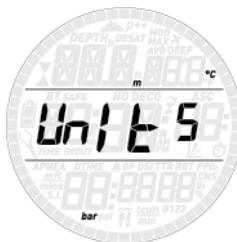
Zde můžete volit mezi metrickou (hloubka v metrech, teplota ve °C) a imperiální (hloubka ve stopách, teplota ve °F).
