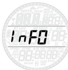
Toto submenu poskytuje informace o hardwaru a softwaru počítače Smart Air a o stavu baterie: **OK** znamená, že baterie je zcela v pořádku, **LO** značí, že je baterie slabá, nicméně stále vydrží na několik příštích ponorů. Písmena **KO** však označují, že baterie je velmi slabá a Smart Air již nebude fungovat jako potápěčský počítač.
