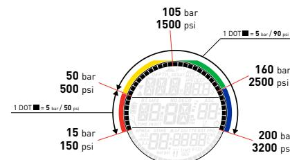
Tlak v lávvi lze zobrazit též v číselné hodnotě, a to stisknutím a přidržením tlačítka **DOWN**. V bezdekomprezním režimu se pak čas ponoru přesune na levou stranu středového rámečku a bezdekomprezní čas je zobrazen vpravo. V dekomprezni režimu je čas ponoru nahrazen tlakem v lávvi. Opětovným stisknutím a podržením tlačítka **DOWN** se displej vrátí zpět na předchozí zobrazení.
