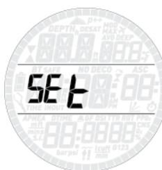
Menu SET v počítači Smart Air umožňuje měnit nastavení. Po vstupu do tohoto menu procházejte pomocí tlačítek UP nebo DOWN dvěma submenu: SET dIVE (Nastavení ponoru), kde můžete nastavit parametry související s ponorem, a SET tIME (Nastavení času), kde nastavujete parametry související s časem a datem.
